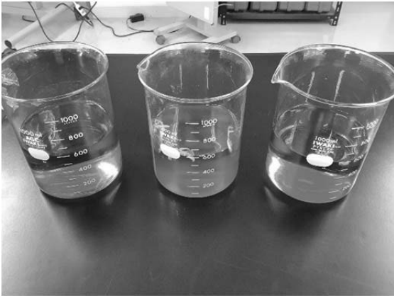
図 8 左はプラスチックペットボトルの破片 中央は生成物 右は何も入れていない
